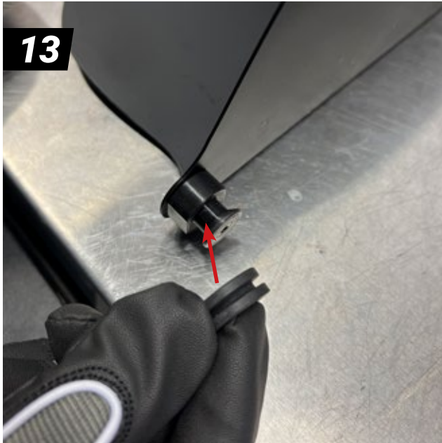
13 Gummiringen monteras på distansen (7).
