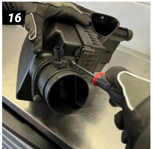
16 Demontera luftmassemätaren från originalets luftbox.
