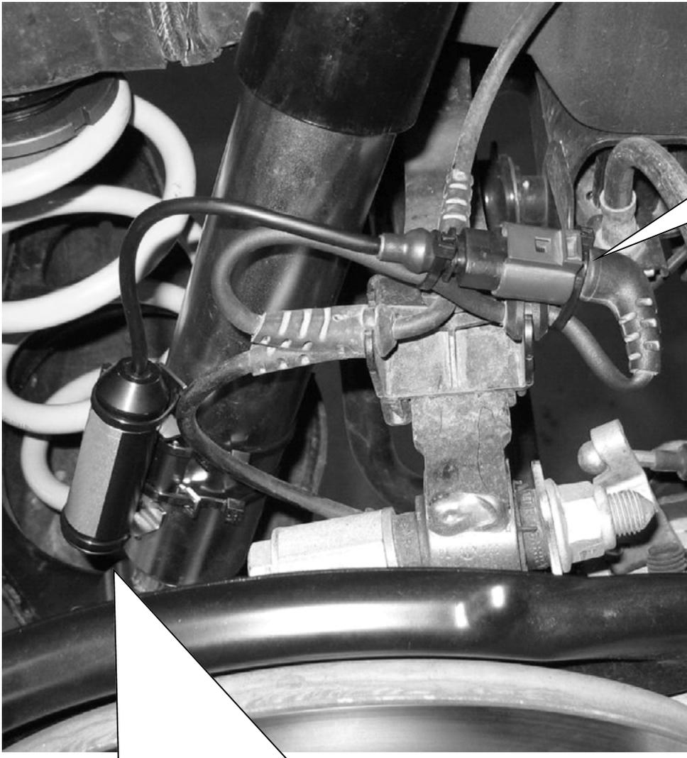
Originale Dämpfersteuerungsleitung mit den kleinen Kabelbinder befestigen.
