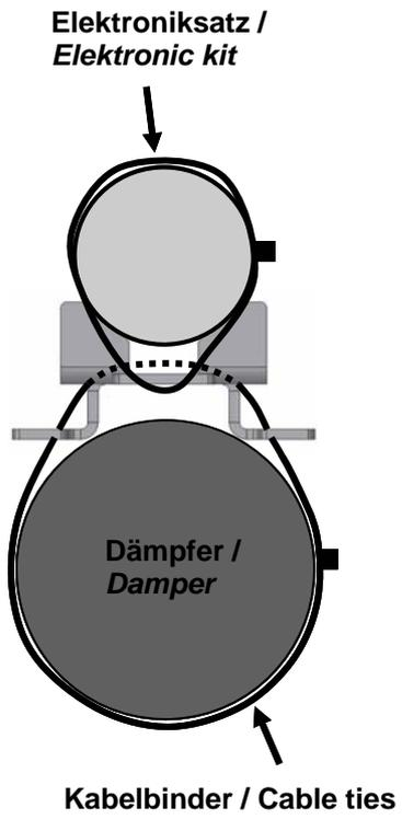
Originale Dämpfersteuerungsleitung um das Federbein herum verlegen und mit den kleinen Kabelbindern befestigen.
