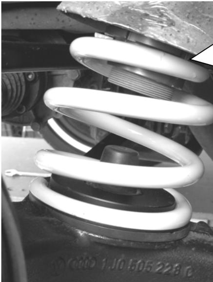
Höhenverstellung und Feder einsetzen, wobei zu beachten ist, dass die serienmäßige obere Federunterlage entfernt wird.
