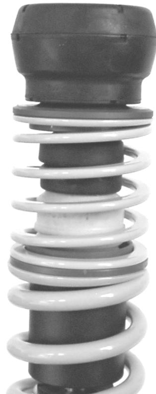
Nach erfolgreichem Einbau des Fahrwerkes ist die Freigängigkeit der Bereifung zum VA Federbein zu überprüfen. Das Mindestabstandsmaß an der engsten Stelle darf **5 mm** nicht unterschreiten und ist gegebenenfalls mittels handelsüblicher, TÜV geprüfter Distanzscheiben wieder herzustellen.
