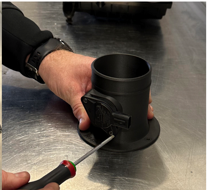
5. Flytta över sensorn för luftmassa till det nya röret med befintlig skruv (torx).
