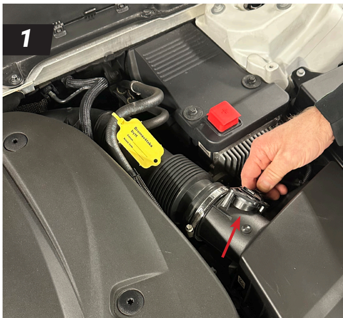
1. Lossa kontakten till luftmassemätaren.
