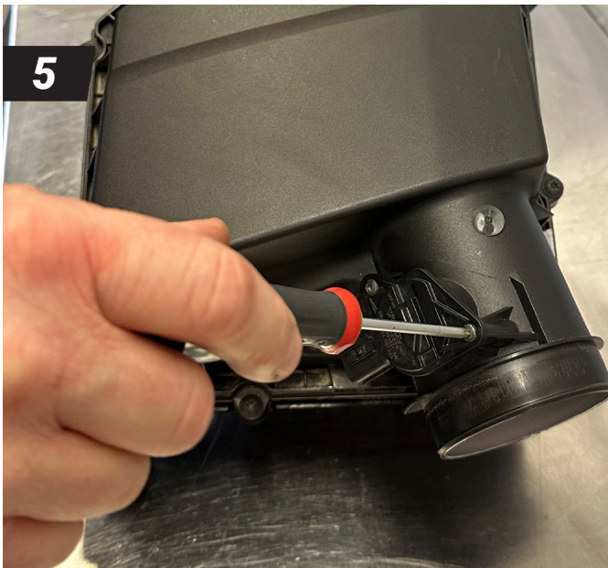
5. Flytta över sensorn för luftmassa till det nya röret med befintlig skruv (torx).
