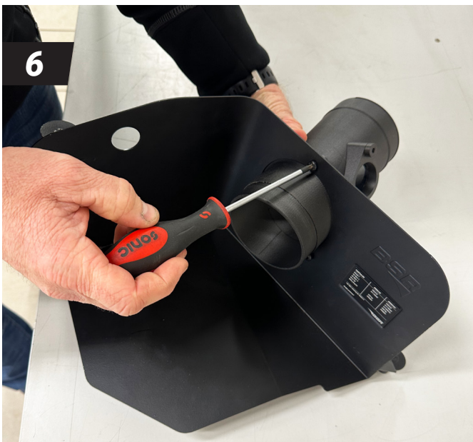
6. Montera rören på avskärmningsplåten.
