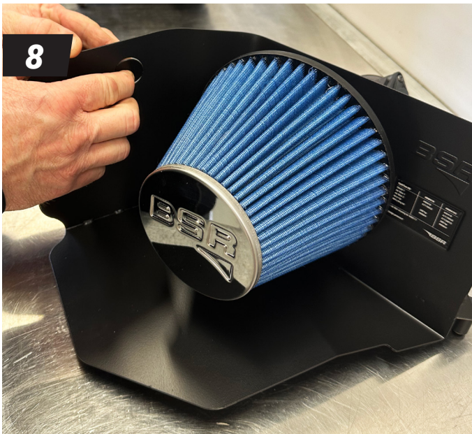
8. Vicka bort bricken för det lilla filtret. *Gäller endast D5-motorer
