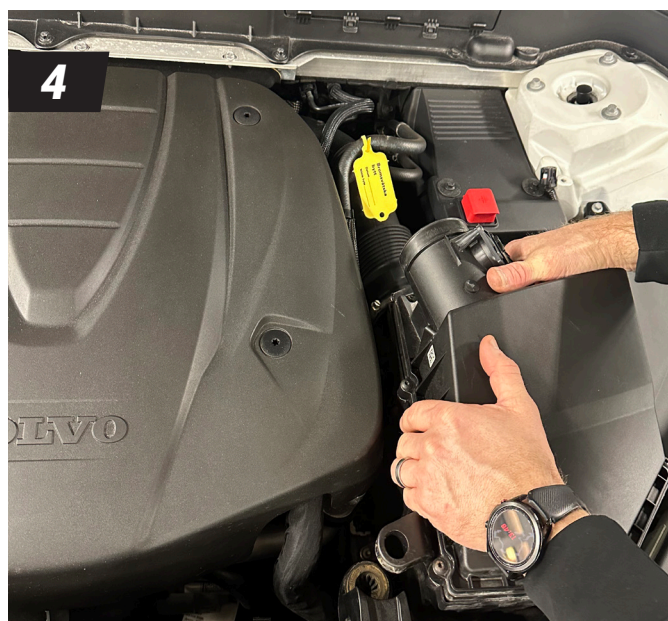
4. Ta bort luftslangen. Ta ett tag om luftboxen och dra uppåt.
