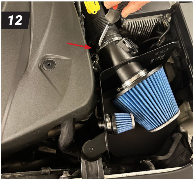
12. Montera luftslangen och dra åt slangklämman.
