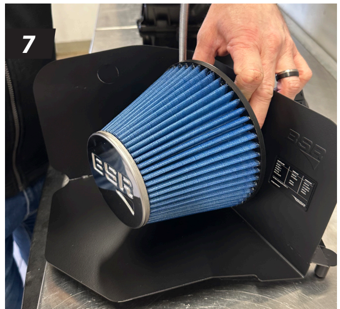
7. Montera luftfiltret med slangklämman. Dra inte för hårt.
